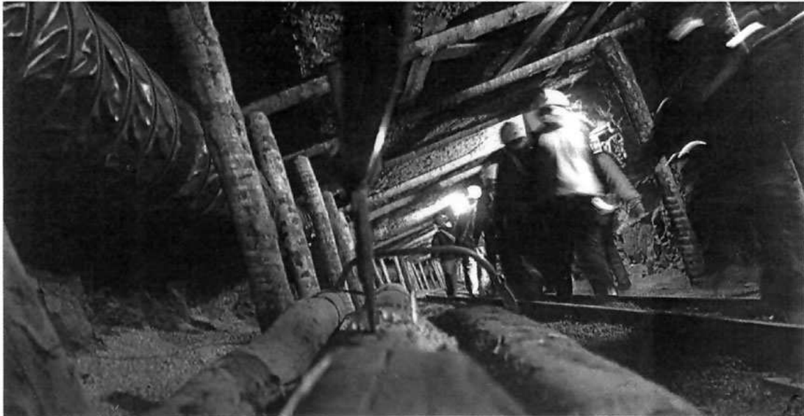
Los entibados de madera reforzaban el interior de las galerías y alertaban con sus crujiidos de posibles hundimientos. ANTONIO GARCÍA
